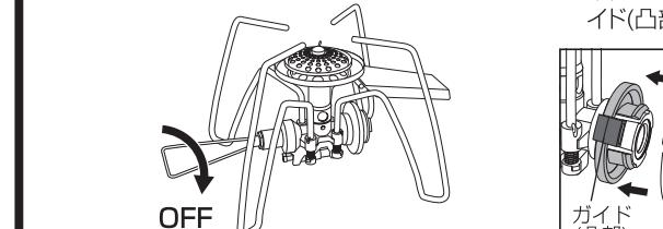
②ポンベホルダーのガイド(凸部)が所定の位置(左側に止まるまで回した位置)にあることを確認します。容器(ボンベ)の切り込み部をガイド(凸部)に合わせ矢印方向に押し付けます。
