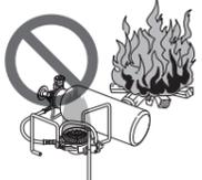
•Vergewissern Sie sich vor dem Anzünden des Kochers, dass kein Brennstoff austritt. Brechen Sie die Verwendung des Kochers sofort ab, wenn ein Brennstoffleck gefunden wird. Entzünden Sie niemals einen Kocher, aus dem Brennstoff austritt.
